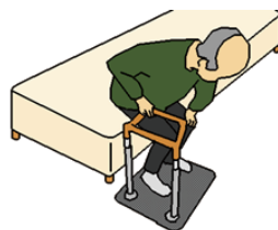
図2) すべり止め加工された設置型の手すり
